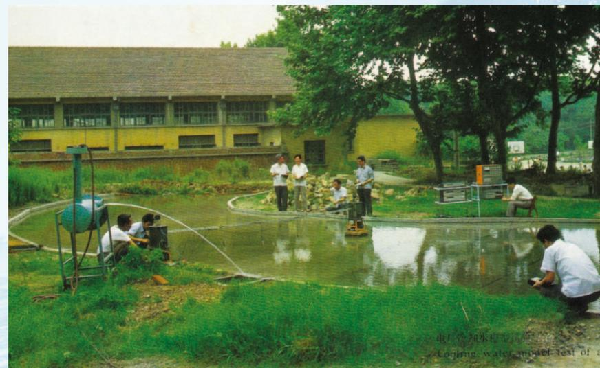
电厂冷却水模型实验
