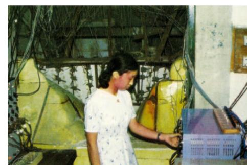
拱坝结构动态模型实验
