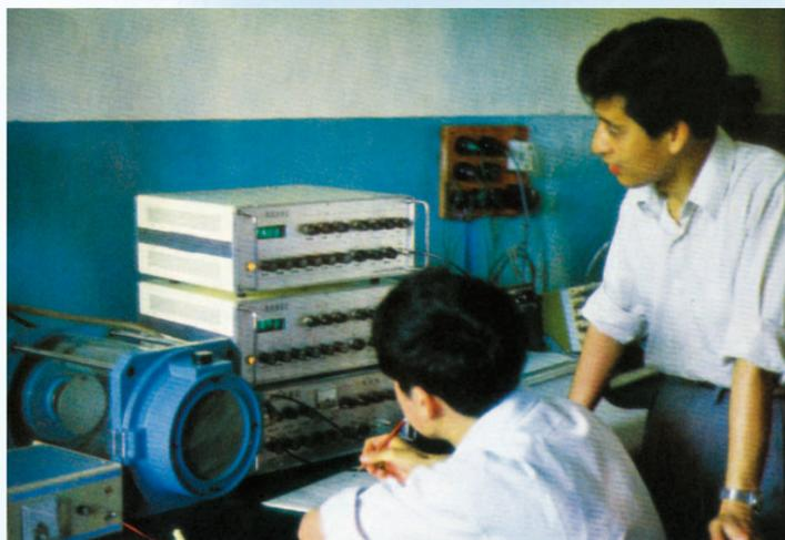
水工所自行设计的 HWL-1 型热线流速仪
